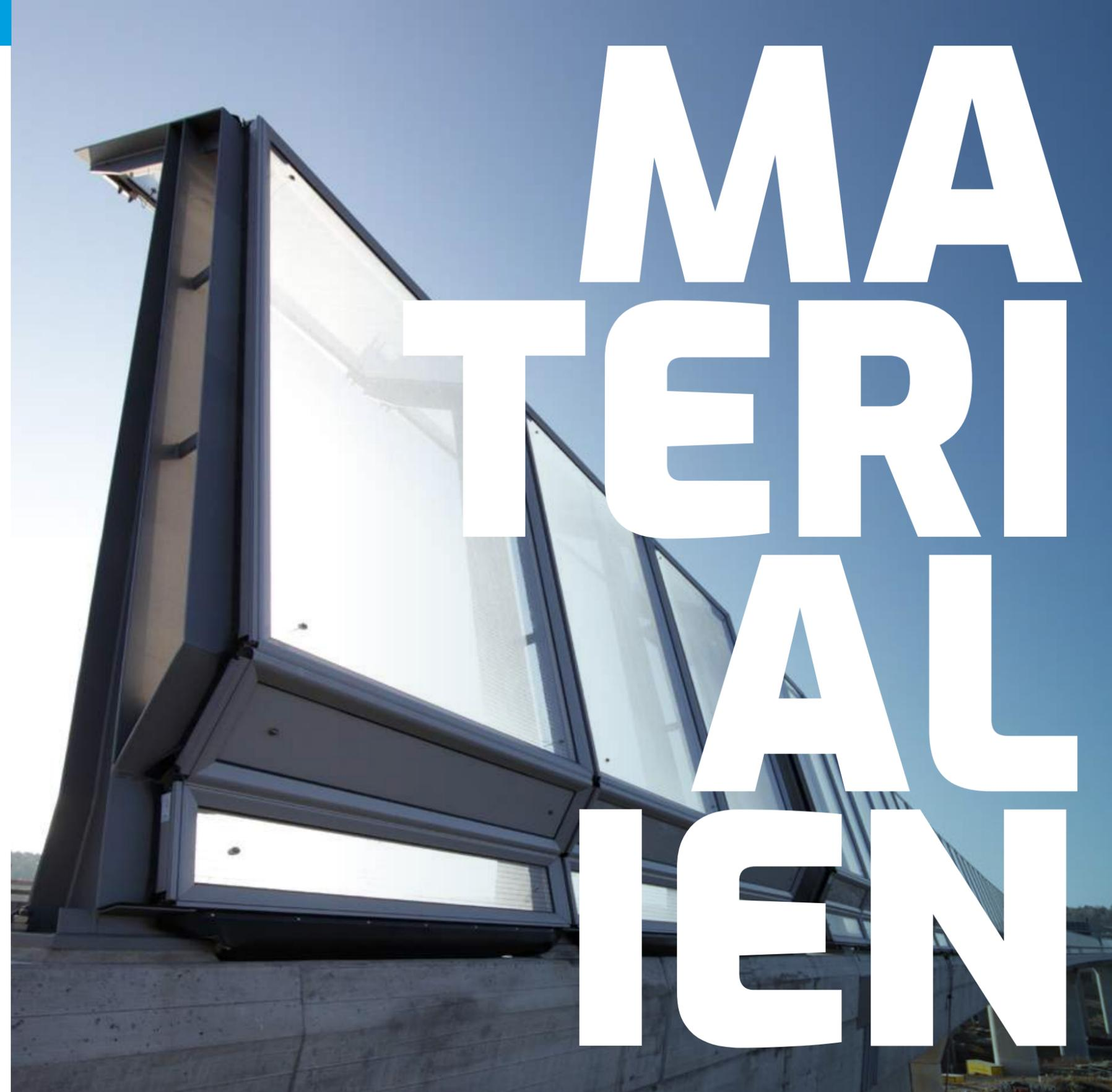
**Extrudiertes Acrylglas XT** zeichnet sich durch exzellente optische Eigenschaften, Langlebigkeit sowie beste Schallschutzeigenschaften aus. Es wird in einem Extrusionsverfahren hergestellt, bei dem das thermoplastische Acrylgranulat aufgeschmolzen und über Kalandrierwalzen in Plattenform gebracht wird. Dabei entstehen bis zu 25 mm dicke Massivplatten mit sehr geringen Dicketoleranzen.
