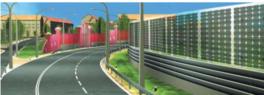
Bild 1: Tradition und Zukunft, PV-Lärmschutzwand als 3D-Bild
